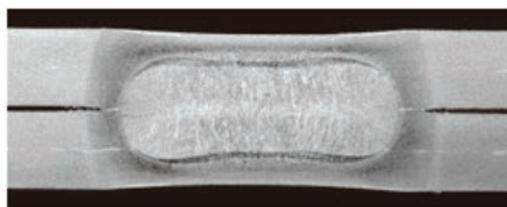
แนวเชื่อมแบบ Spot Welding
